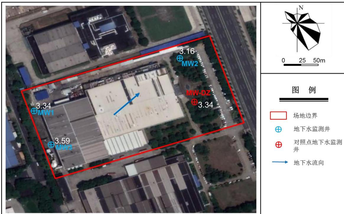
图 6-1 场地浅层地下水位流向示意图
