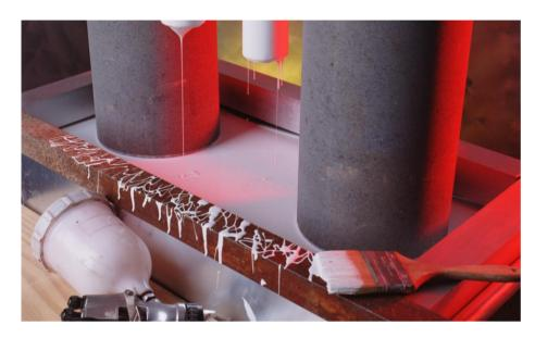
Combat 氮化硼涂料是完全无机性的涂料,由氮化硼粉末和高温键合相构成。它们以适于刷涂的液体形式提供,也可以用水稀释至适合于喷涂和浸渍的稠度,适用于多种渗透性和非渗透性材料,包括石墨、金属和陶瓷。
