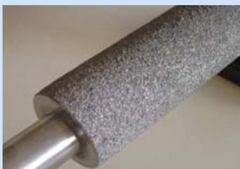
在造纸业的应用中, 软线喷枪喷涂防滑和耐磨涂层 (>60HRc), 涂层粗糙度高于20μm。
