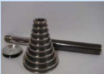
使用软线喷枪喷涂陶瓷棒, 产生高耐磨涂层, 比等离子喷涂涂层耐磨性高。
