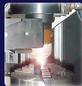
枪头: 适用于镍基、铁基和钴基合金, 碳化物等。可制造 0.5mm-7mm 涂层。焊层为 2-3 层。
