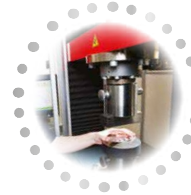
弹簧刚度测试设备
