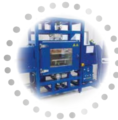
转向Yoke测试设备
