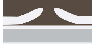
图 5: NORGLIDE® SMALC100CG。此产品的钢层也有铝包层。在此解决方案中，延展拉伸的铝合金网可用于整形提高精度。此 NORGLIDE® SMALC 解决方案的总厚度为 1.00 mm。
