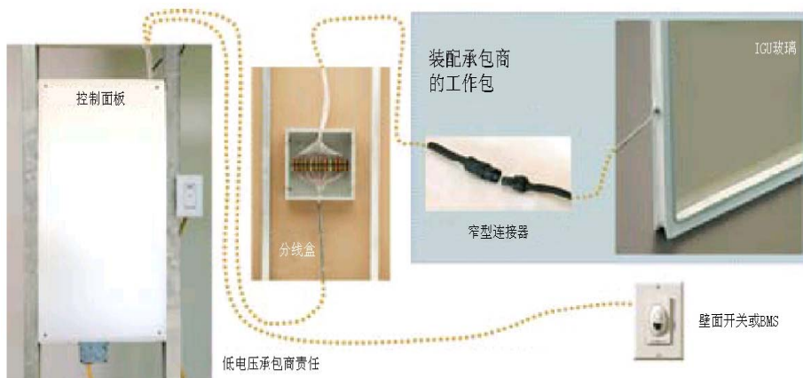
图1 动态调光玻璃图解。玻璃装配承包商负责窗框配线、安装玻璃并进行连接。电力承包商负责室内接线。注意:IGU引出的尾纤连接到一个线型连接器上,窗框配线应使用与之匹配的连接。配线和连接器只有一种闭锁方式,这样能保证正确、紧固的连接。
