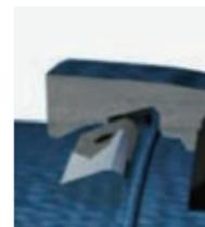
管道回拖,是为了止脱环尽可能的和承口止脱腔的最大斜面接触,形成有效的止脱结构。
