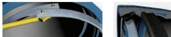
止脱环方向根据管道承口内的止脱腔的形状使用专用工具或者直接使用手工变形(根据不同口径选择),窄面朝外,宽面朝里,如图右放置在止脱腔。
