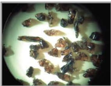
如图所示，NorZon氧化锆磨粒可以不断破裂脱落，然后露出新的切削刃。这种砂轮在其80%的使用周期内都能保持锋利。此外，诺顿拥有专利的独创结合工艺能使磨料附着时间更长，从而最大限度地发挥每个磨粒的磨削力。
