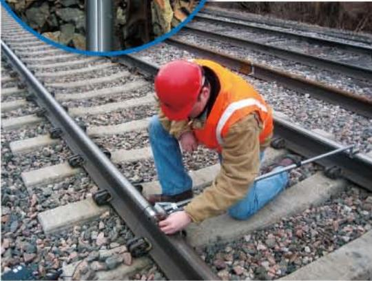
MiniProf 是一种用于检测铁路道岔情况的手持式工具。使用时，MiniProf 利用本身的磁性紧贴在轨头轮廓表面，并利用一根可拉长的伸缩杆将另一根铁轨作为参照物。
