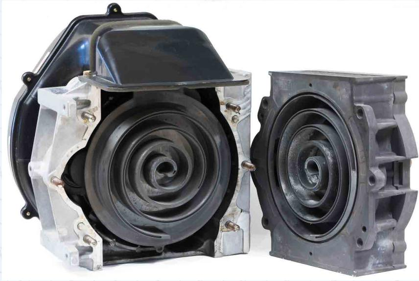
针对不同规格的无油涡旋压缩机，
